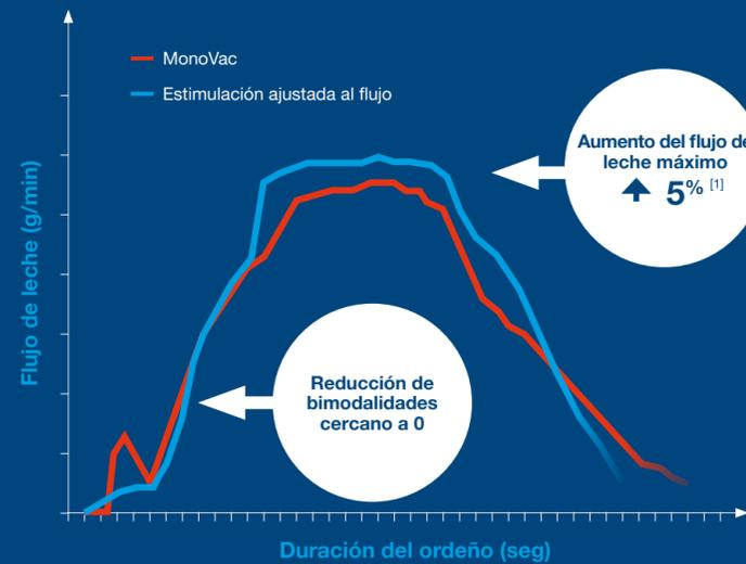
**i** Durante la fase de estimulación, el vacío aplicado es de sólo 34 kPa, la pulsación de 30/70 con 50 bpm. La fase principal es de 42-44 kPa, pulsación 65/35 y 60 bpm. El nivel de desconexión está entre 300-1000 g/min.
