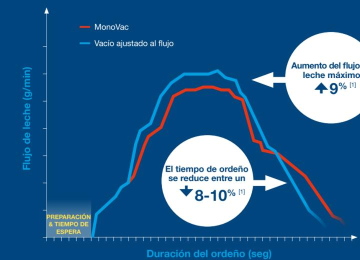
**i** En la fase de inicio, tras una estimulación adecuada, los niveles de vacío son de 42 kPa, pulsación 65/35 con 60 ppm. Cuando el flujo alcanza >2kg/min, se inicia la Fase Principal y los niveles de vacío se incrementan a 47-49 kPa, pulsación 65/35 y 60 ppm.
